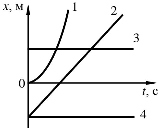
Равномерному движению с отличной от нуля скоростью соответствует график
